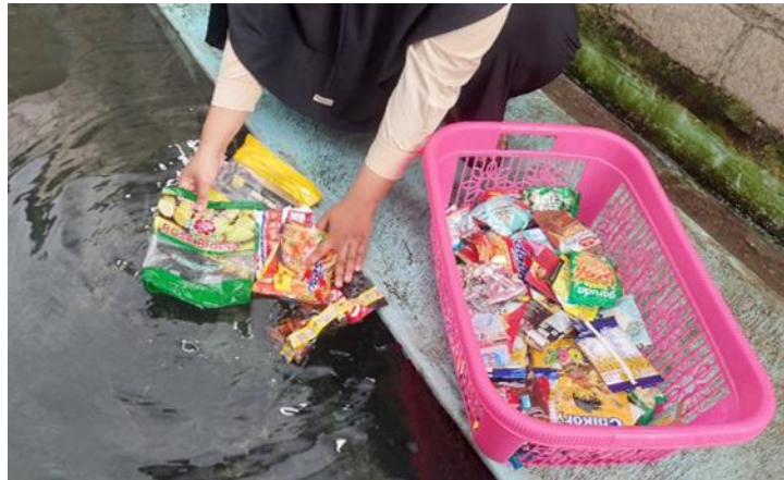
Gambar 4. Proses pencucian sampah plastik sebelum diolah menjadi ecobrick
